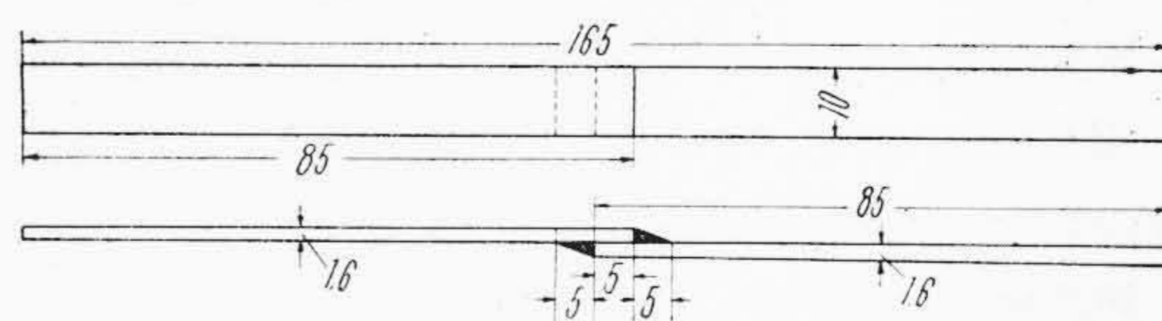
第2図 剪断強度試験片 Fig. 2. Shear Test Specimen
