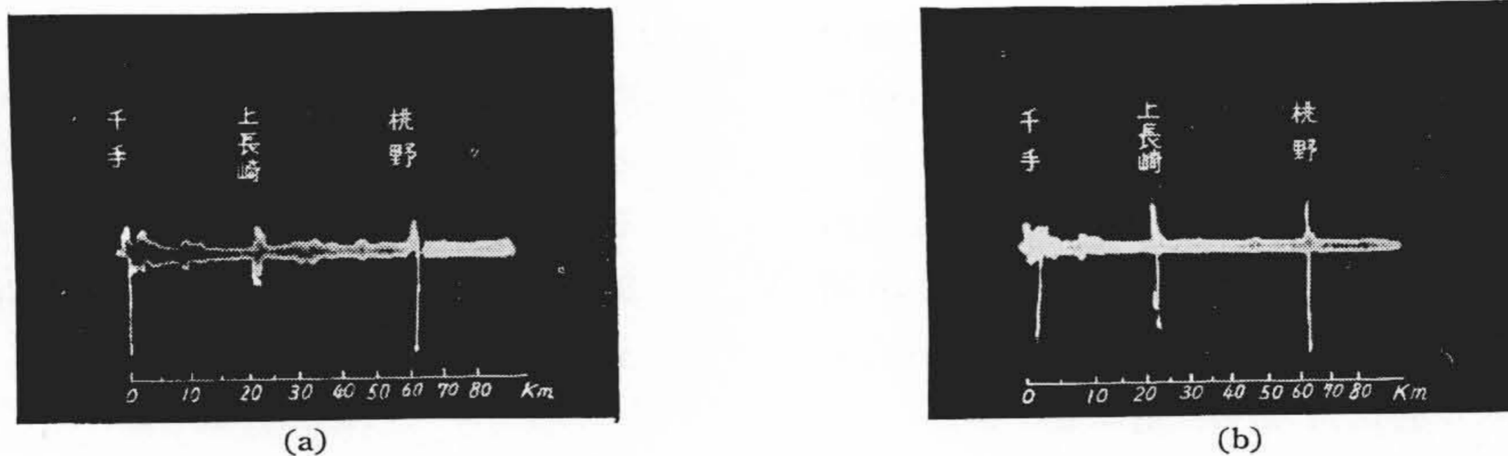
第4図 人工故障試験オッシログラム
