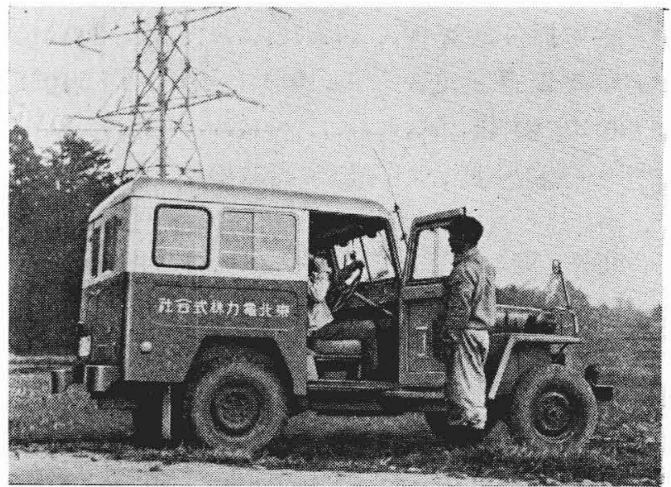
第7図 25 W 移動局を搭載したサービスカー (東北電力株式会社)
