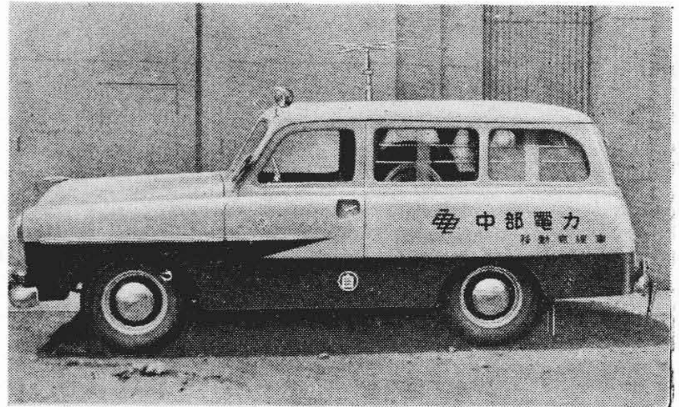
第6図 25 W 移動局を搭載したサービスカー (中部電力株式会社)
