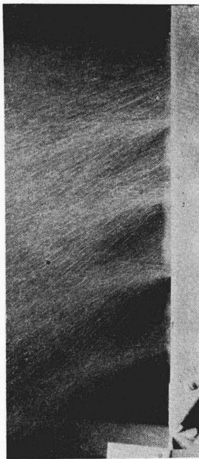
第16図 調節羽根角度を 15^\circ にしたときの微粉の流出状況
