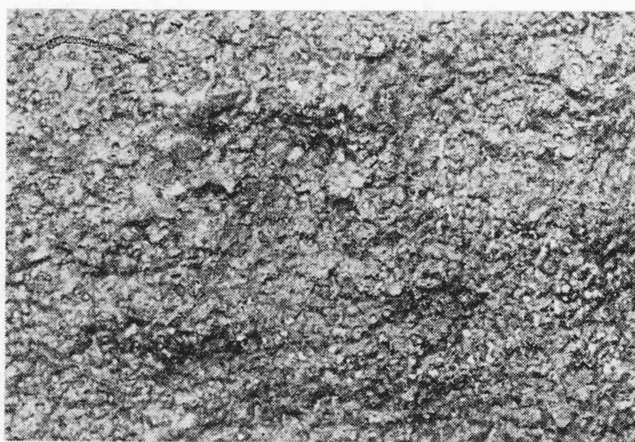
第20図 変質したシヤモット質B煉瓦の表面 Fig.20. Surface of Chamotto Brick B Affected by Molten Steel and Slag
