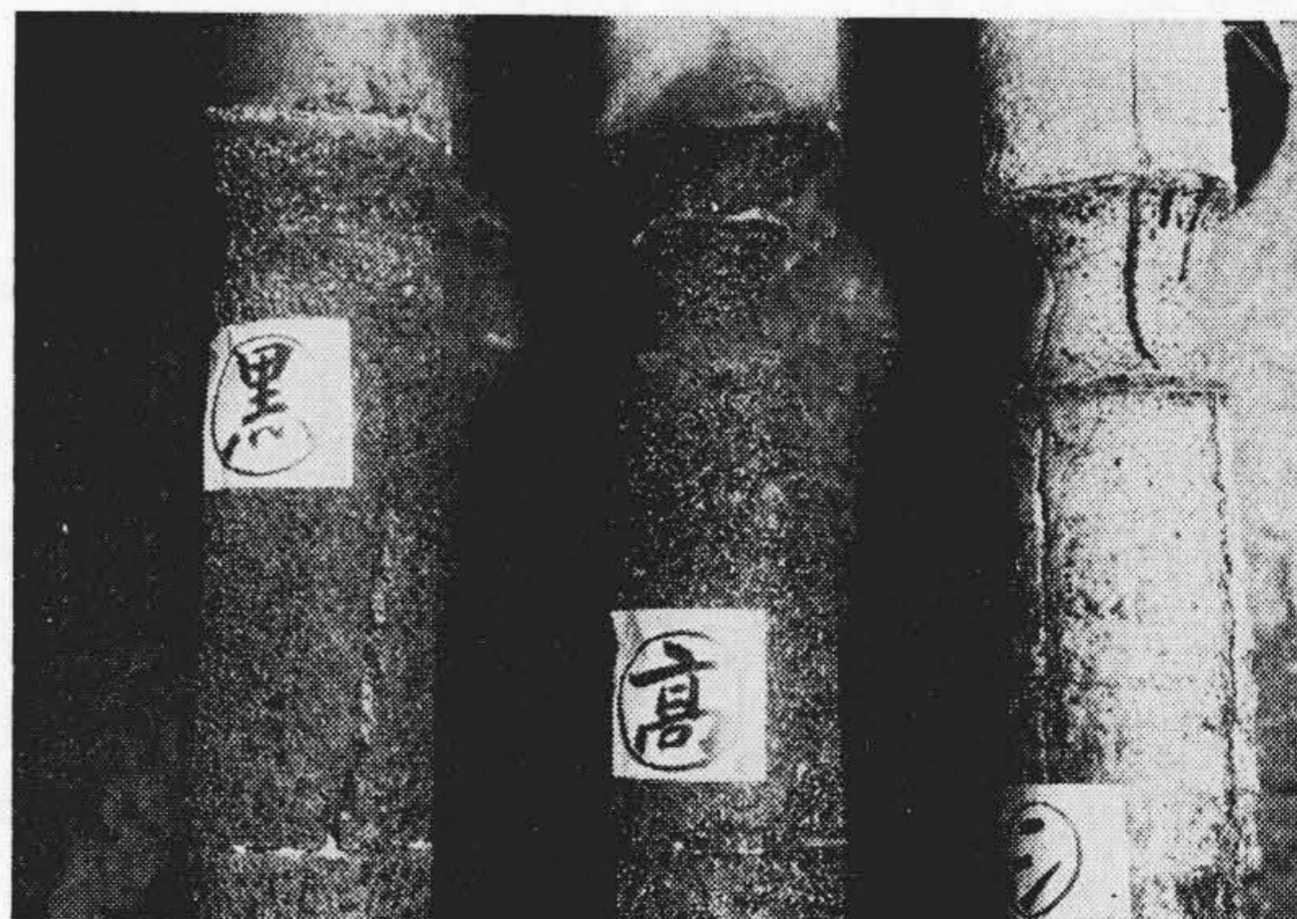
第26図 スラグラインにおけるスリーブ煉瓦の侵蝕 (第2回試験) Fig.26. Erosion Difference of Sleeve Bricks at the Slag Line (No.2 Experiment)
