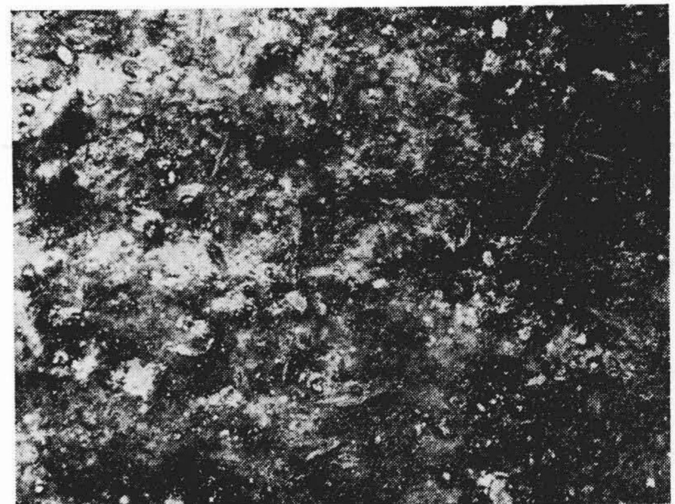
第22図 変質した高アルミナ質B煉瓦の表面 Fig. 22. Surface of High Alumina Brick B Affected by Molten Steel and Slag
