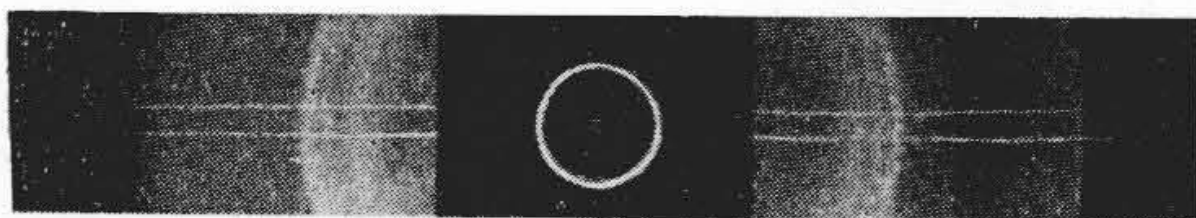
第27図 240mm 2 ACSR 鋼スリーブの X 線廻 折による写真例
