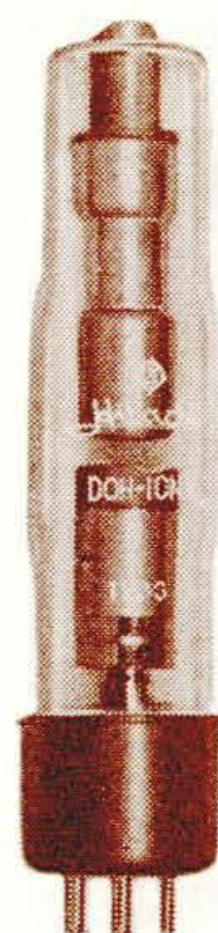
第 10 図 高電圧撮影用 X 線管 DOH-10 NV
