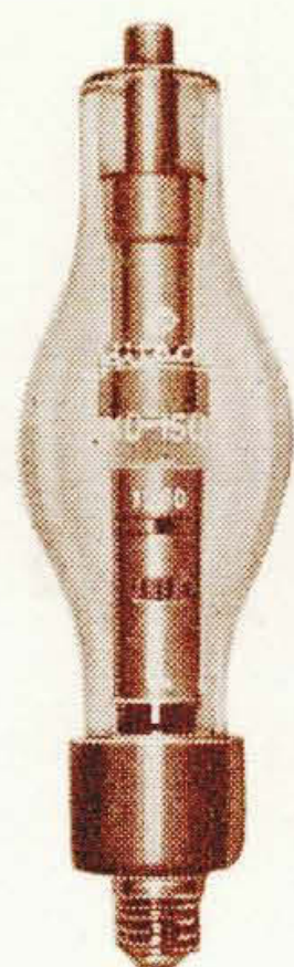
第11図 高電圧用X線整流管 KO-150 Fig. 11. Rectifier Tube KO-150 for X-Ray Unit
