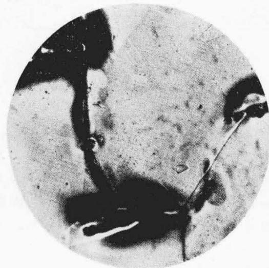
第20図 疲労破壊した鉛表面
