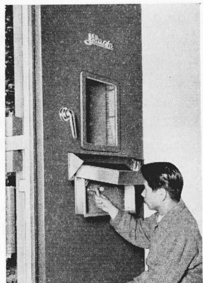
第8図 外扉取付の操作開閉器
