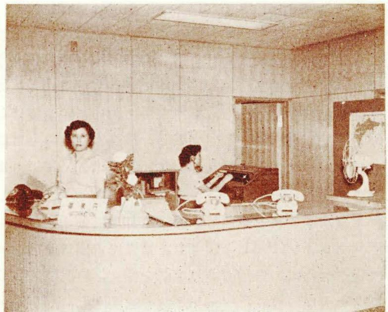
第 18 図 案内所で使用中の 15 回線共電式交換機
