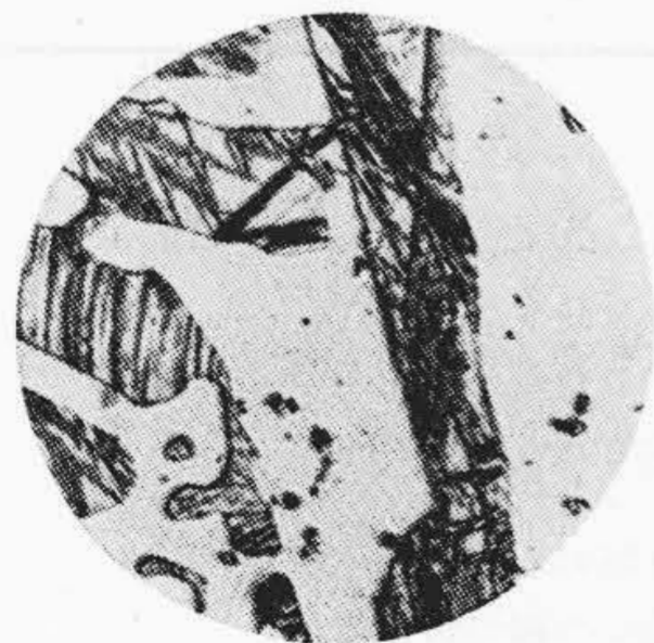
第10図 高硬度チルドロール (ショア硬度82°) の顕微鏡組織 ×500
