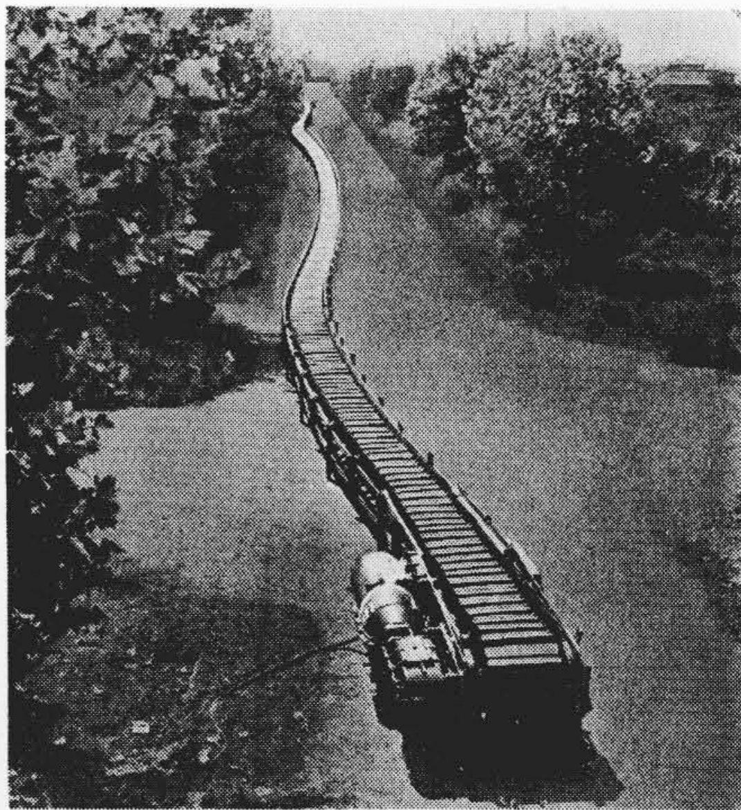
第3図 ECC型カーブドコンベヤ全体図 Fig.3. Type ECC Curved Conveyor
