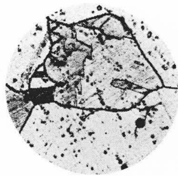
第41図 Nimonic 75, 1,200°C 水冷 800°C 時効 1時間保持 Fig. 41. Nimonic 75, 1,200°C-Water Cooling-800°C Ageing for 1 h
