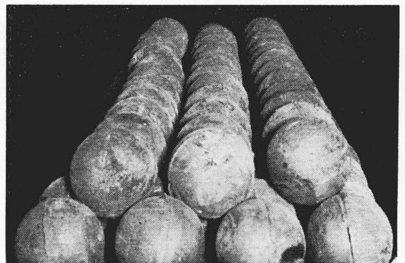
第37図 微粉炭機用ボール Fig. 37. Steel Balls for Pulverizer
