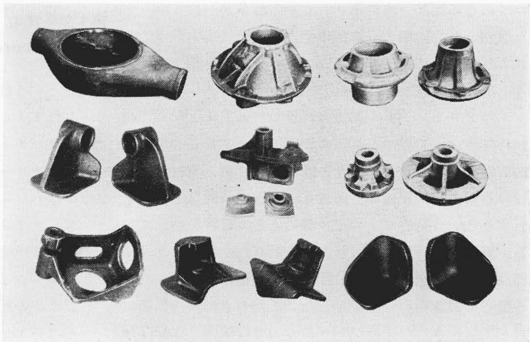
第 1 図 大型自動車用黒心可鍛鑄鉄部品 Fig. 1. Malleable Castings for Automobile Parts (Large Type)
