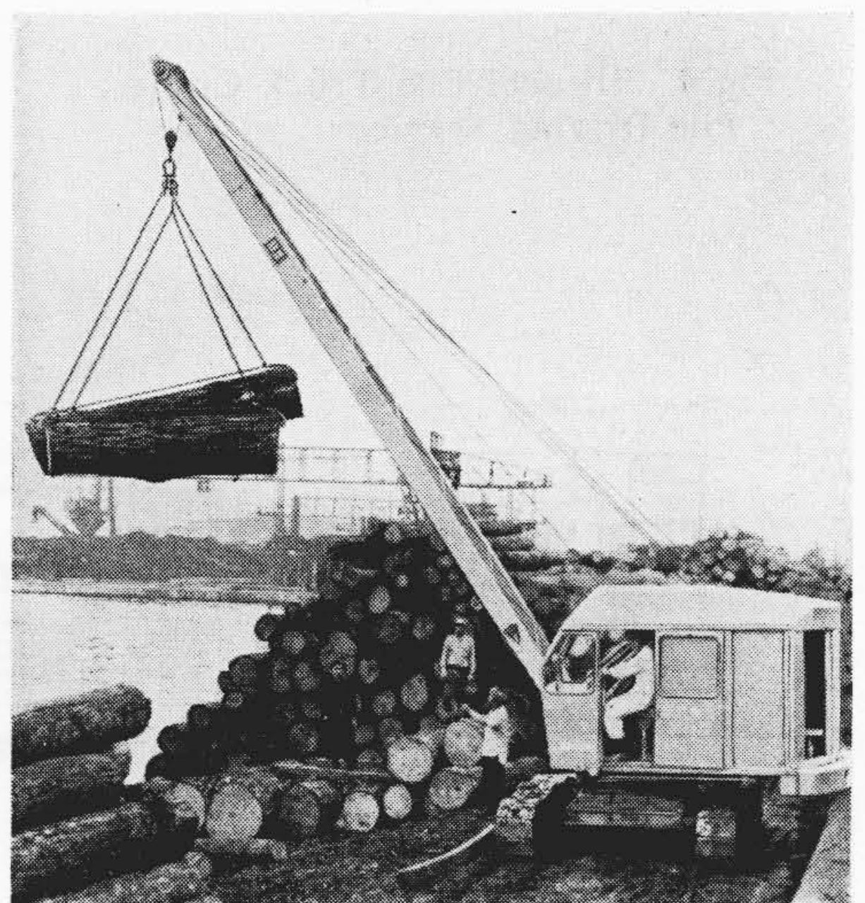
第2図 材木陸揚中の日立 U03 クレーン Fig.2. Hitachi U03 Crawler Crane in the Log Handling Service
