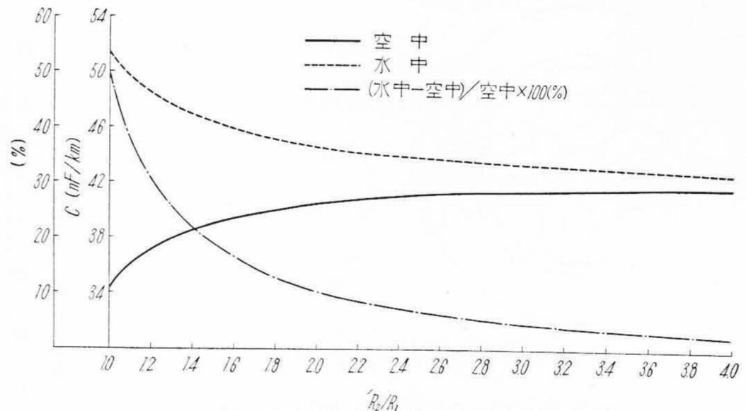
第 7 図 PVC シース厚みを増加してゆくときの静電容量の変化
