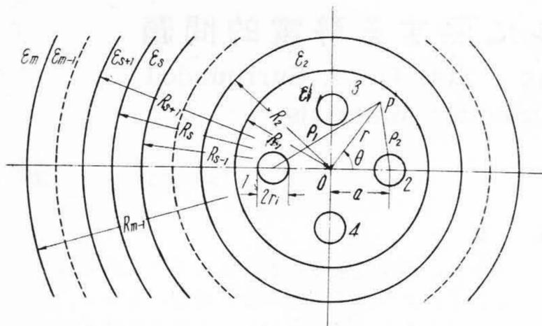
第 1 図 数層の誘電体シースで包囲された星型カッドの断面
