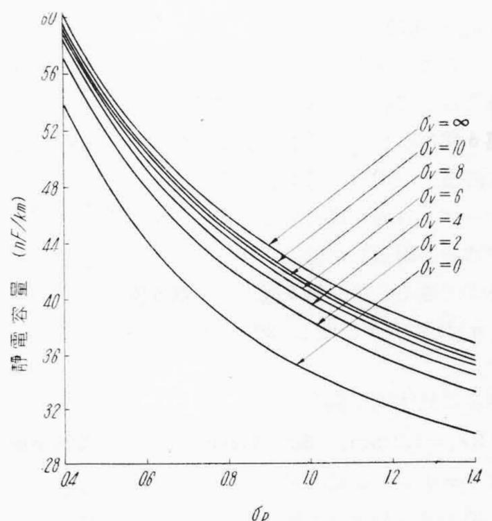
第6図 ケーブルを水に浸したときの実回線の静電容量と  $\sigma_v$  および  $\sigma_p$  との関係
