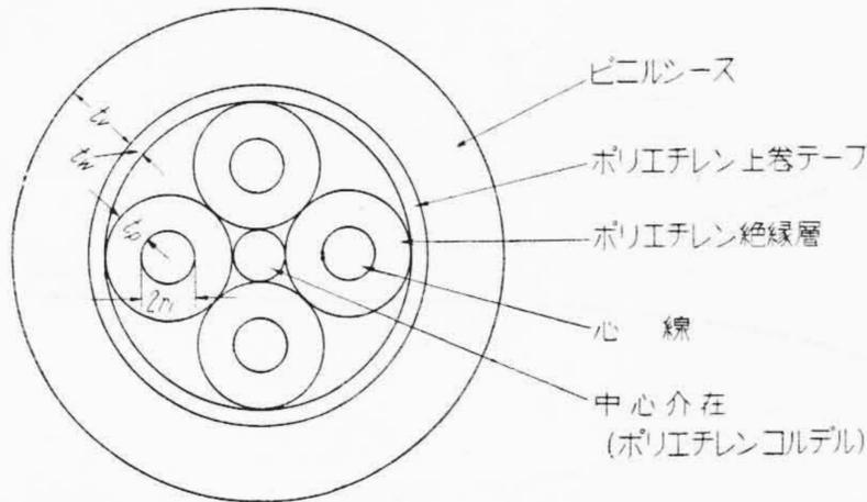
第4図 ポリエチレン絶縁ビニル被覆の星型カッドの断面
