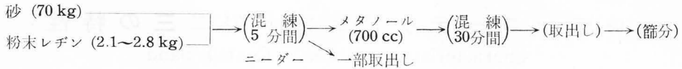
第1図 レジンコーテッドサンドの製造法 Fig.1. Cold Process to Make Resin Coated Sand
