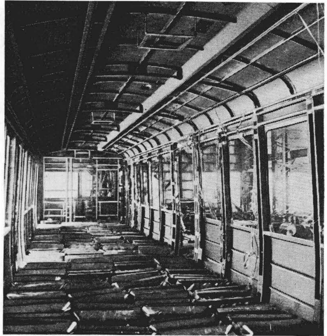
第4図 曲げ試験負荷状況 Fig. 4. Imposing Load for the Bending Test
