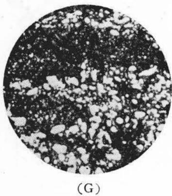
第9図 SKH3 据込鍛造のマイクロ組織 (G) 鍛造比  $5 \rightarrow \frac{1}{2}$  据込  $\times 3$  位置  $\frac{D}{5}$   $\times 200$
