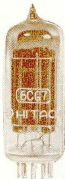
第 10 図 双 3 極 mT 管 6CG7 Fig. 10. Triode 6CG7
