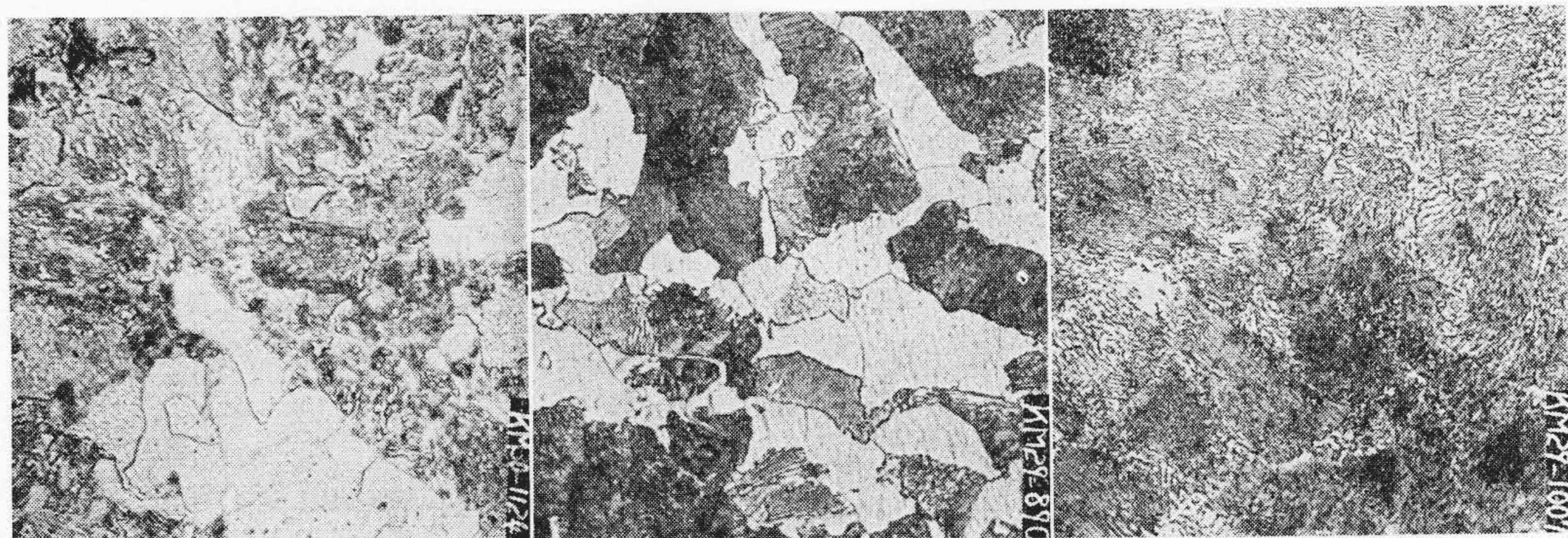
第5図 低 Mn-Mo 鋳鋼の焼鈍組織の例 ×400
