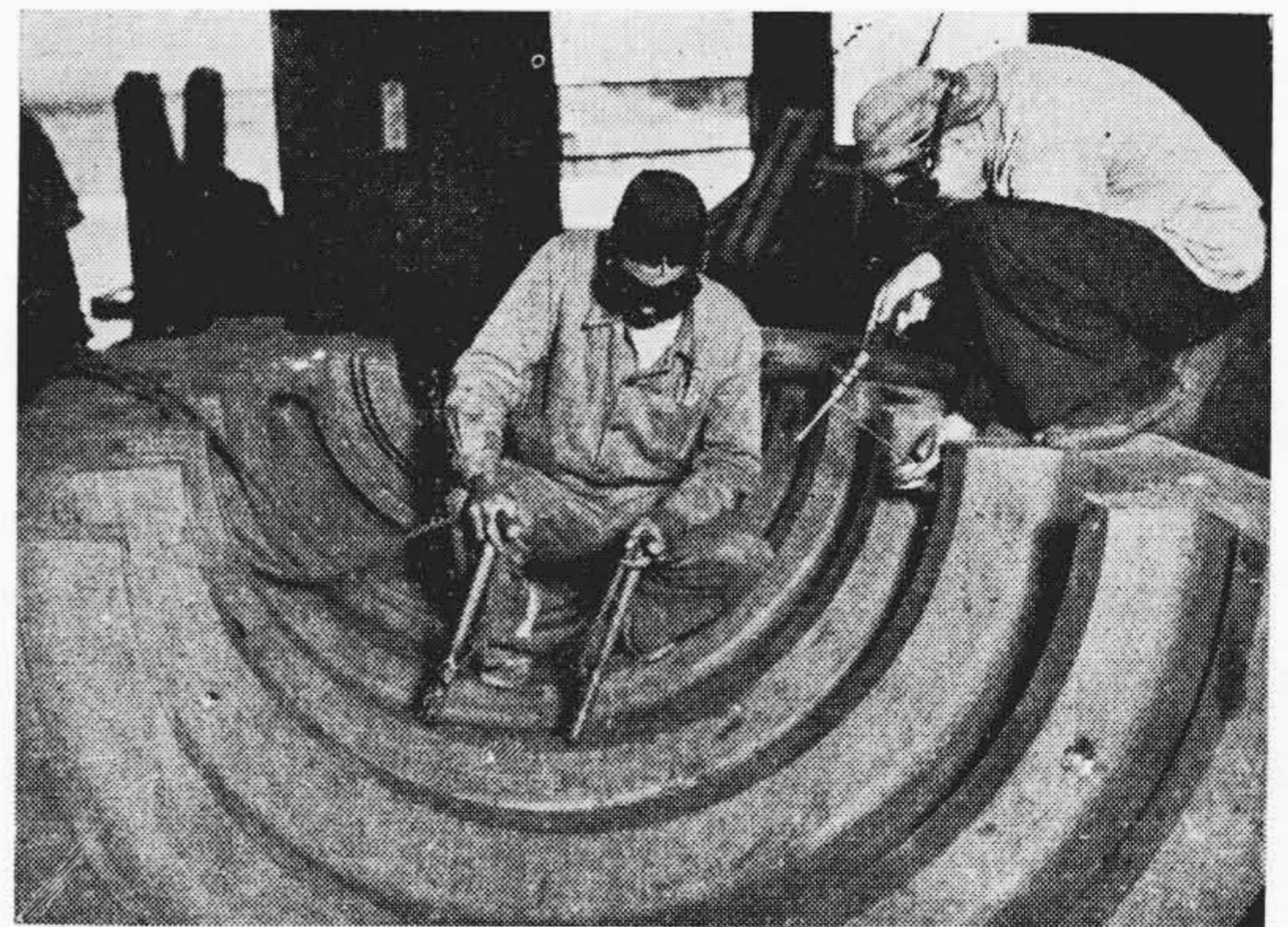
第21図 高圧ケーシングの磁気探傷試験 Fig. 21. Magna Flux Test of High Pressure Shell
