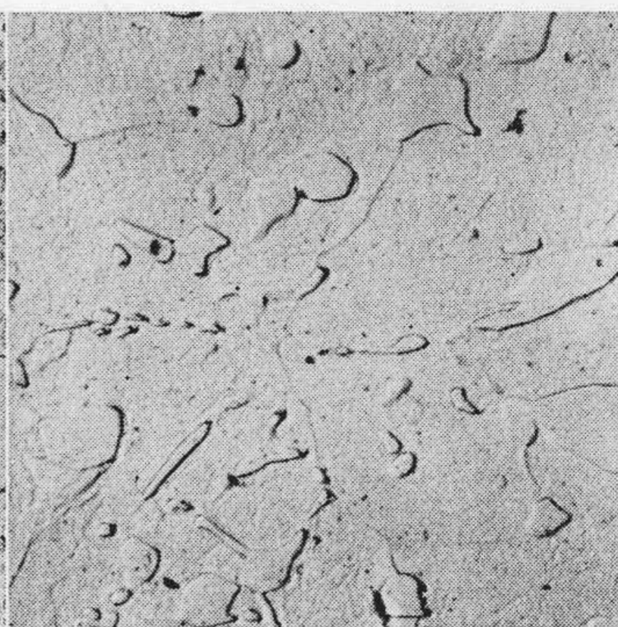
第6図 刃物鋼（第4図のもの）電解研磨後3%硝酸アルコール腐蝕（×2,000）
