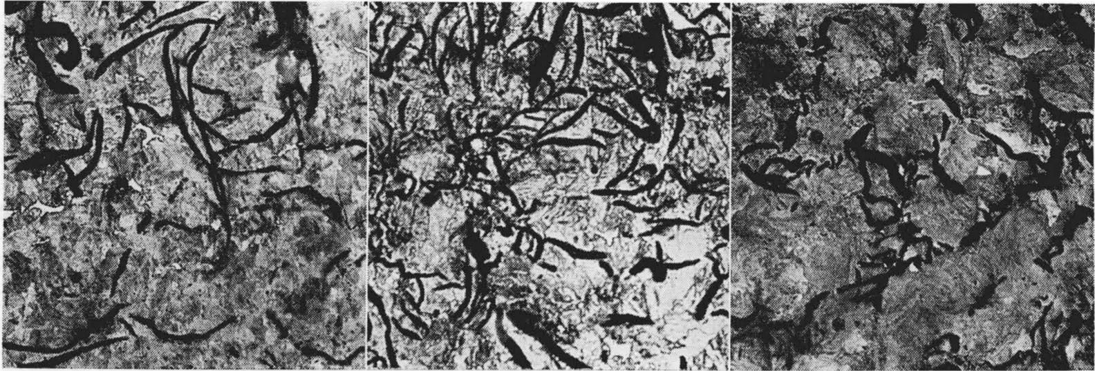
第8図 電解鉄加炭鉄の組織
