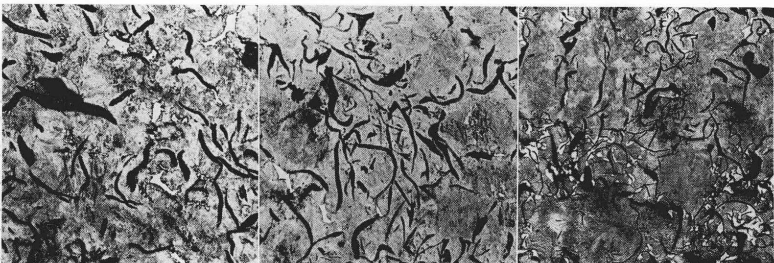
第11図 弧光炉還元鉄加炭鉄の組織
