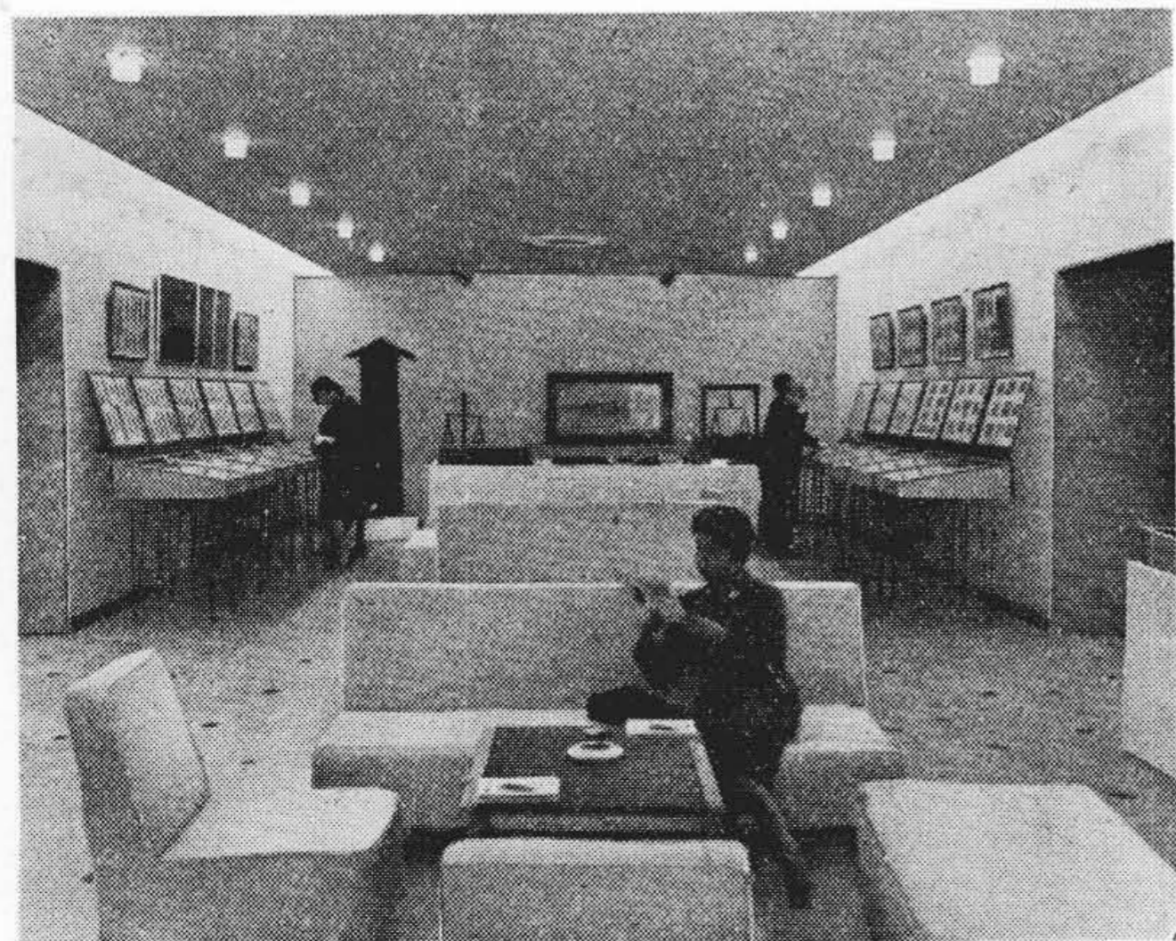
第25図 陳列室の蛍光灯器具とダウンライトによる照明
