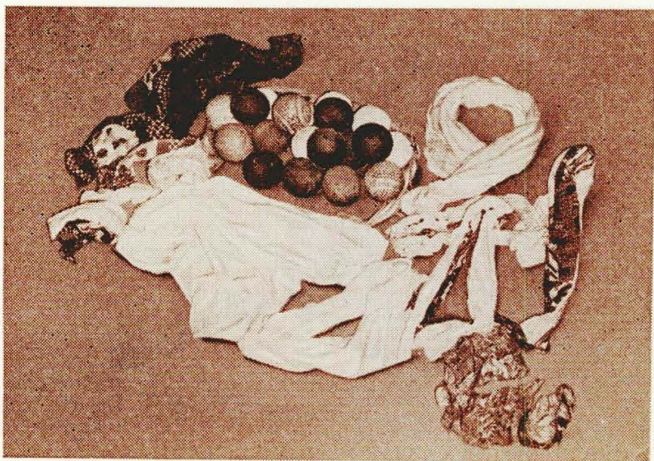
第3図 100mm ブレードレスポンプによつて送られた異物類
