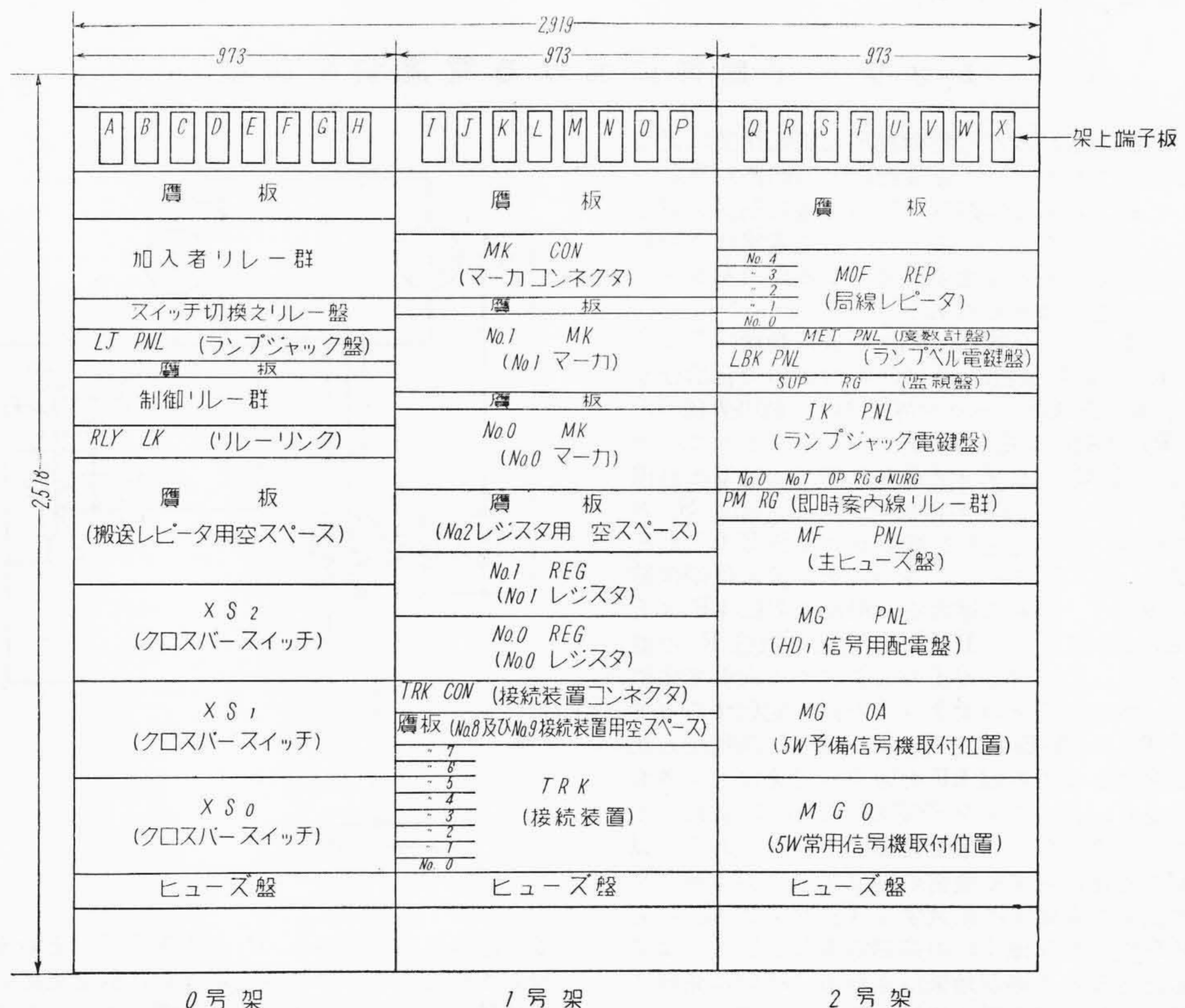
第4図 HXC-2A形 クロスバー式自動交換機実装図
