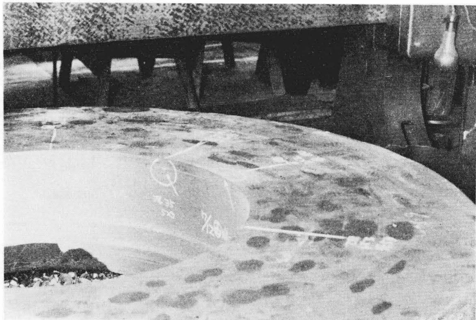
第6図 輪材内孔周辺に現れた砂かみ (No. 9)
