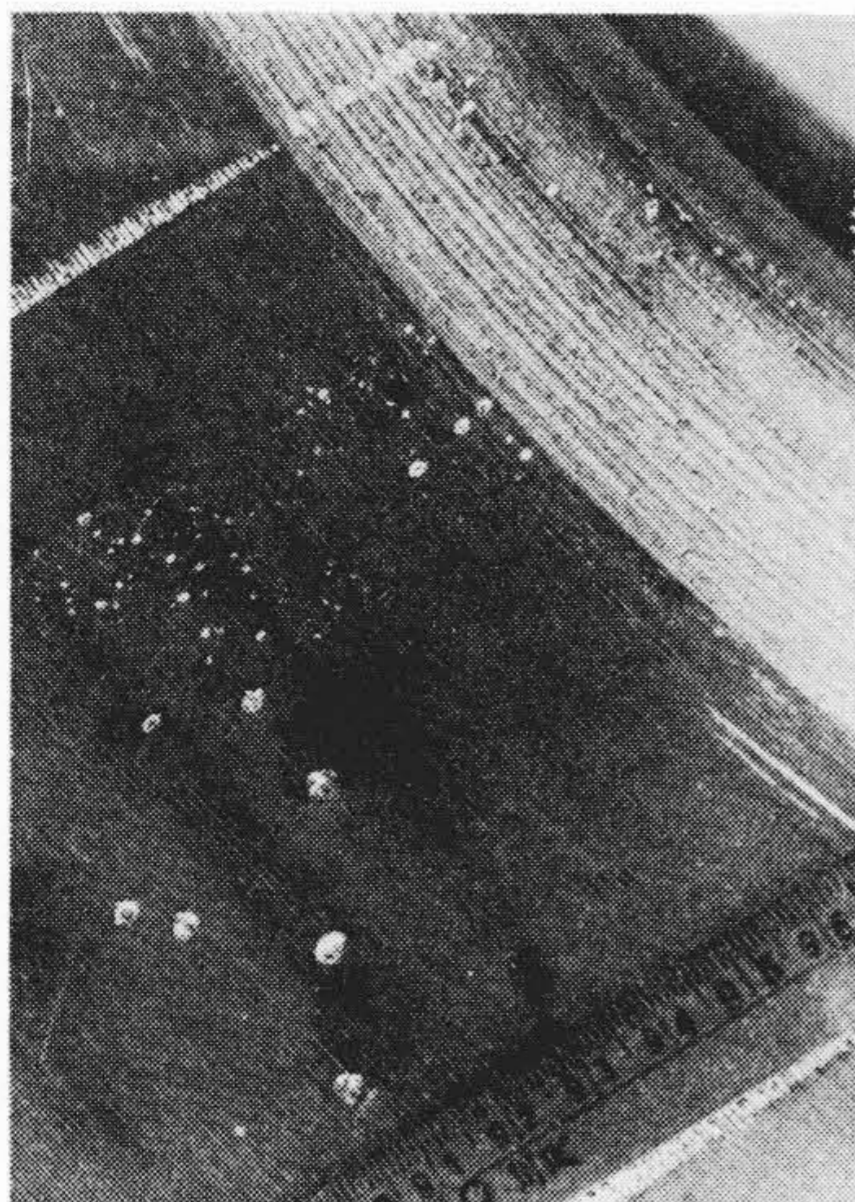
第5図 シャフトフランジ端面に現れた砂かみ (No. 5)
