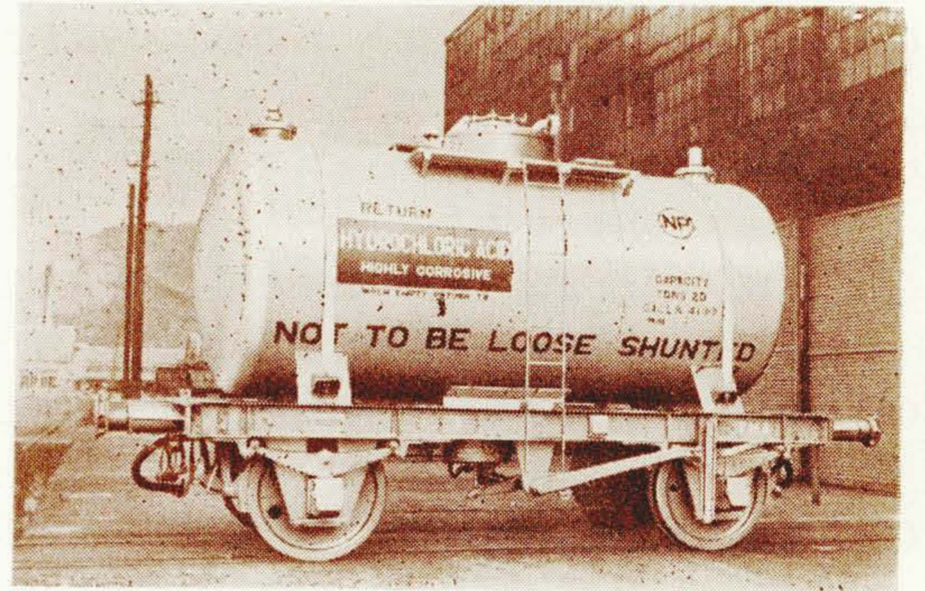
第7図 インド政府鉄道塩酸タンク車
