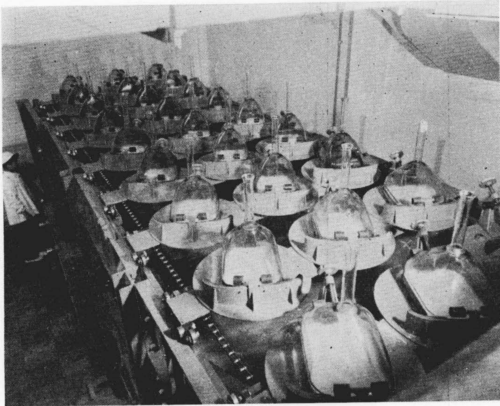
第3図 コンベヤ式蛍光膜塗布機
