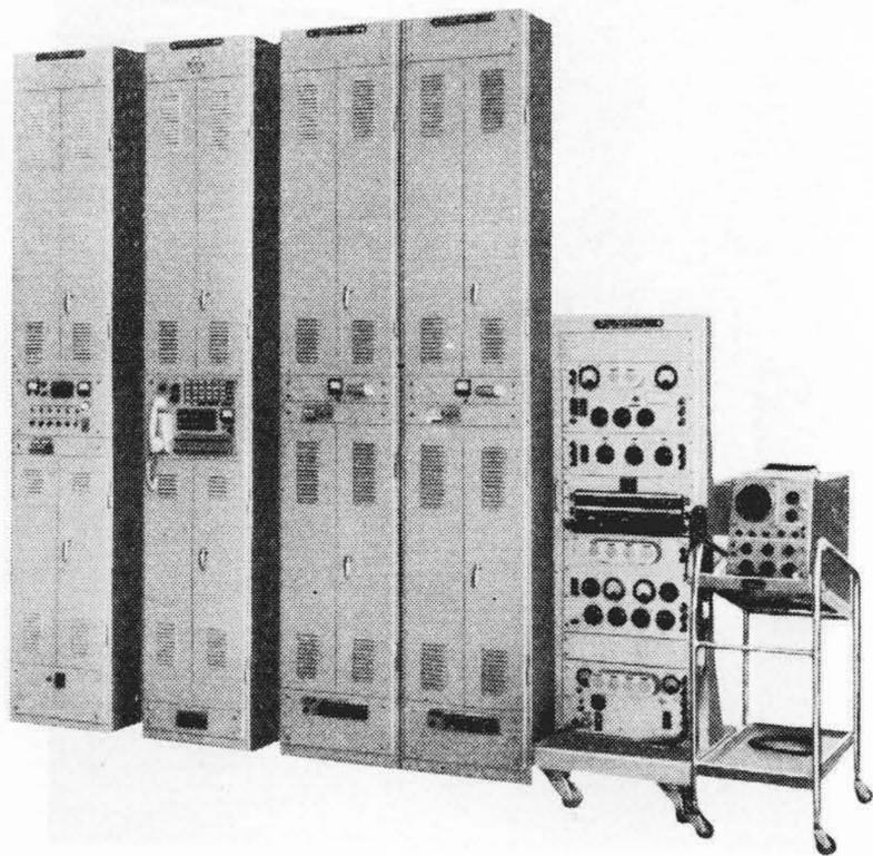
第 7 図 MT-2701 型 PPM 端局装置
