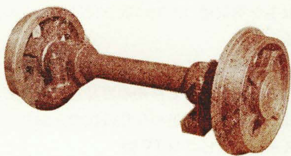
第11図 キルンカーに取り付けられる車輪
