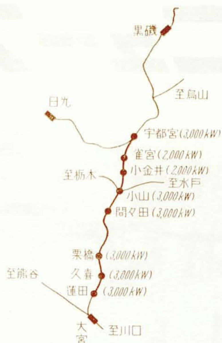
第2図 国鉄東北線直流無人変電所配置図
