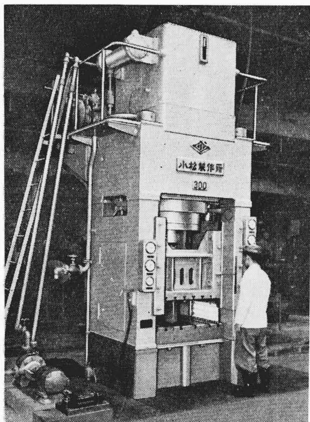
第8図 大型油圧プレス Fig. 8. 300 t Single Action Hydraulic Press
