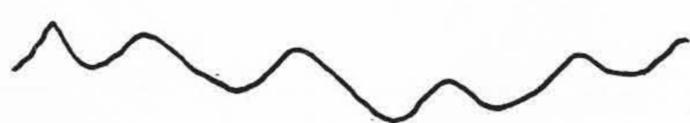
第5図 電話線にかかる静電誘導電圧の波型 (電話線大地間)
