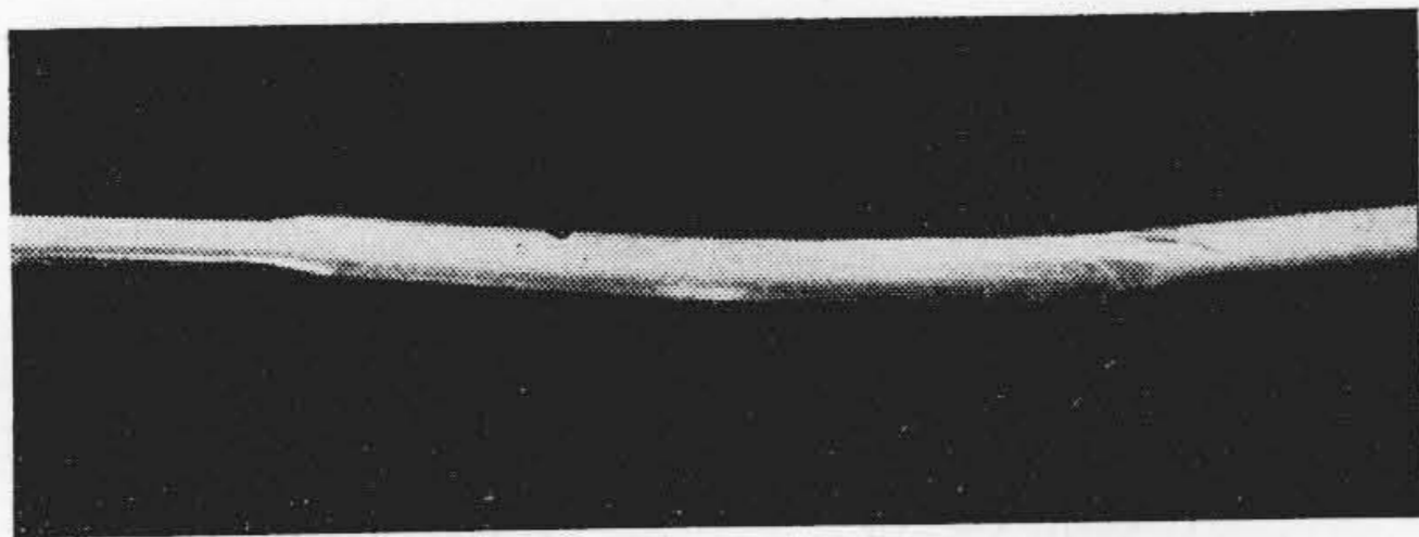
第11図 振れた引抜材の一例
