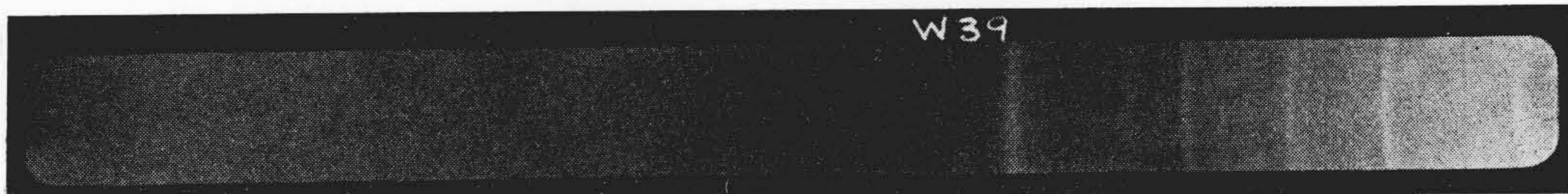
第6図 特級 Al 2 O 3 のX線回折写真 α-Al 2 O 3 -H 2 O を示す (対陰極 Cu, 電圧 45 kV, 電流 10 mA, 露出 60 分, Ni フィルタ)
