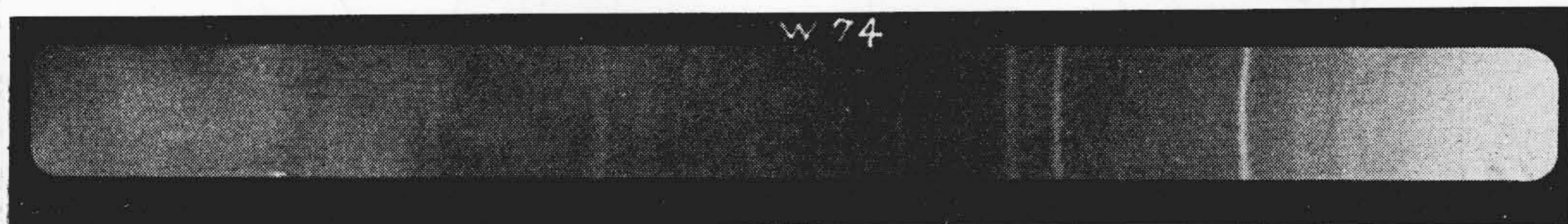
第8図 一級 MgO を珪素鋼表面に塗付 1,200°C 1時間 H 2 中焼鈍した場合の珪素鋼表面粉末の X 線回折写真 (対陰極 Cu, 電圧 45 kV, 電流 10 mA, 露出 60 分, Ni フィルタ)
