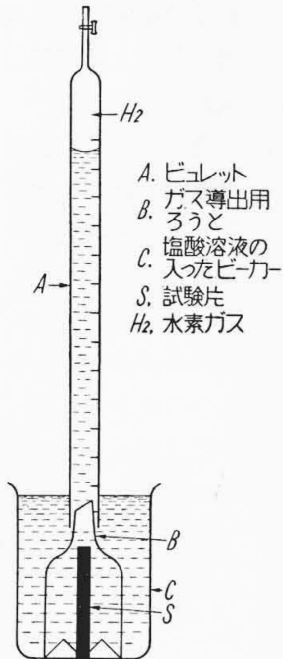
第6図 塩酸によるガス発生装置
