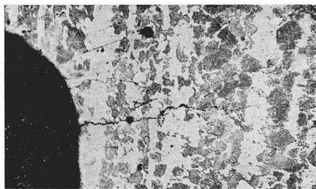
第6図 疲れ亀裂 \times 100 (13kg/mm 2 , 10 7 回で破断せず)
