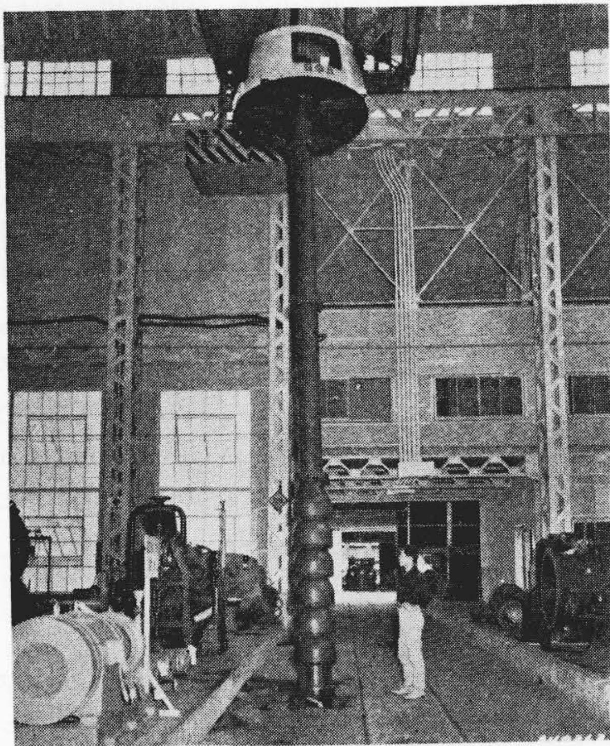
第 18 図 東北電力八戸火力発電所納 250HP 立形灰処理ポンプ
