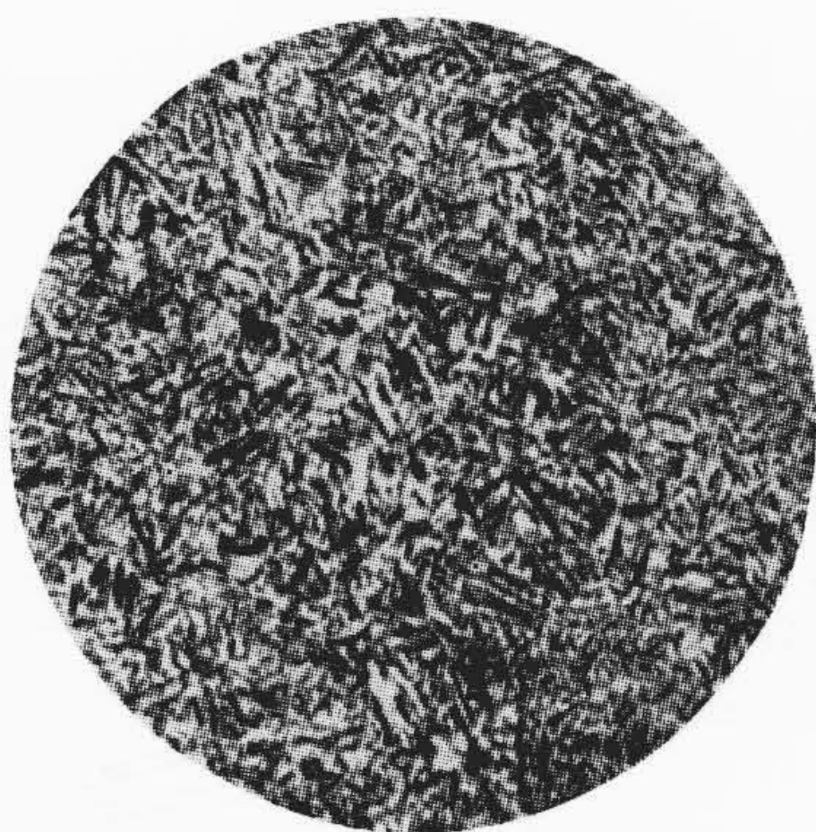
第2図 R1 試料の 1,050°C 油焼入組織 (×420)
