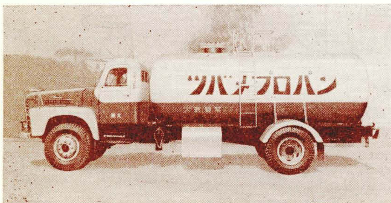
第3図 プロパン・タンクローリ
