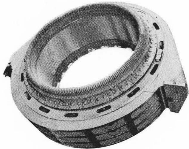
第2図 圧延用誘導電動機の固定子
