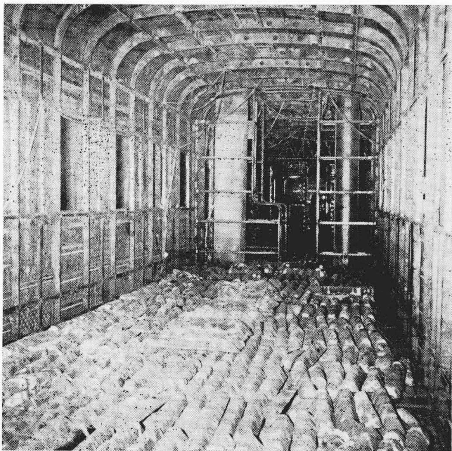
第14図 鋼体強度試験
