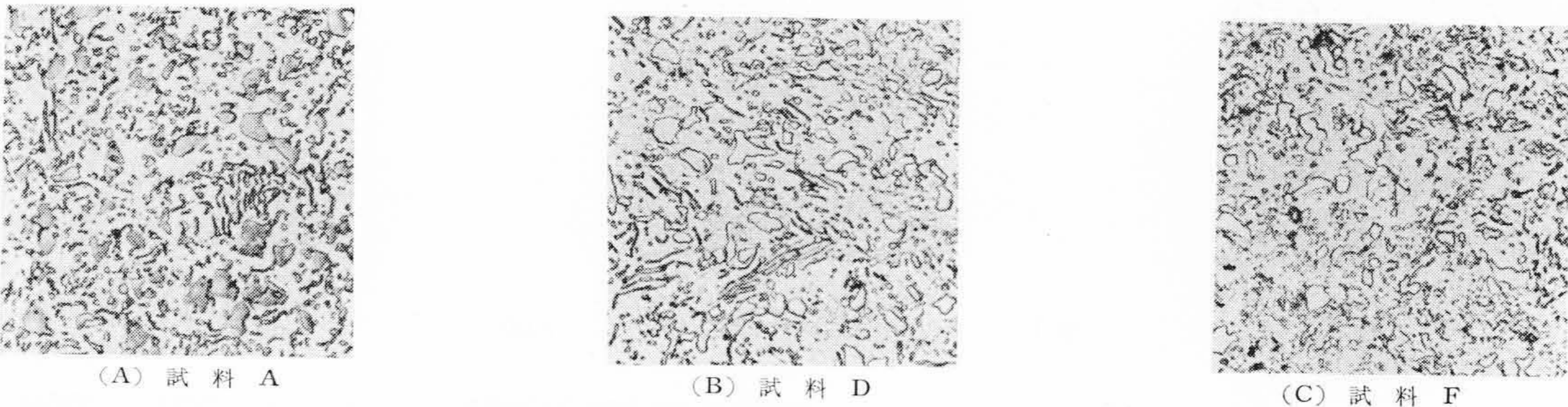
第5図 850°C×40分焼鈍試料の顕微鏡組織 (×420)
