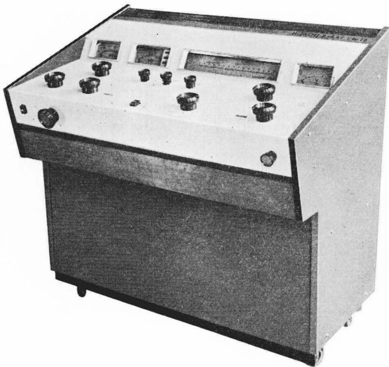
第13図 X線装置の制御装置
