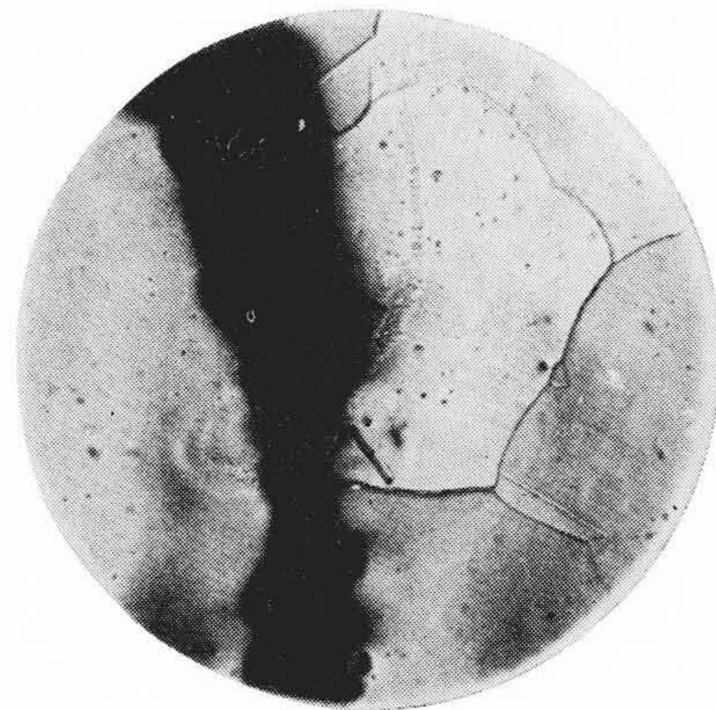
第 11 図 破断部の組織 (×100)
