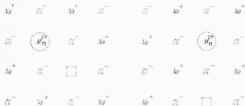
第10図 NaClにおける格子欠陥の生成
