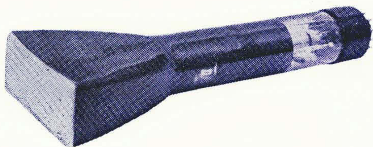
第 17 図 角形観測用ブラウン管 3 AHP 1
