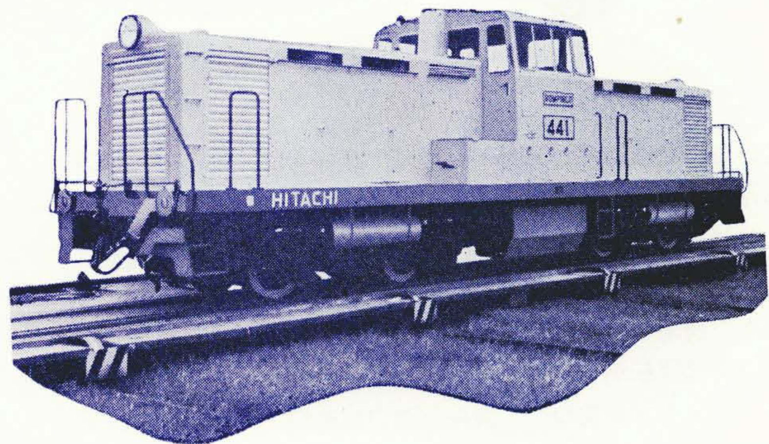
第8図 45t 1,100 PS 液体式ディーゼル機関車
