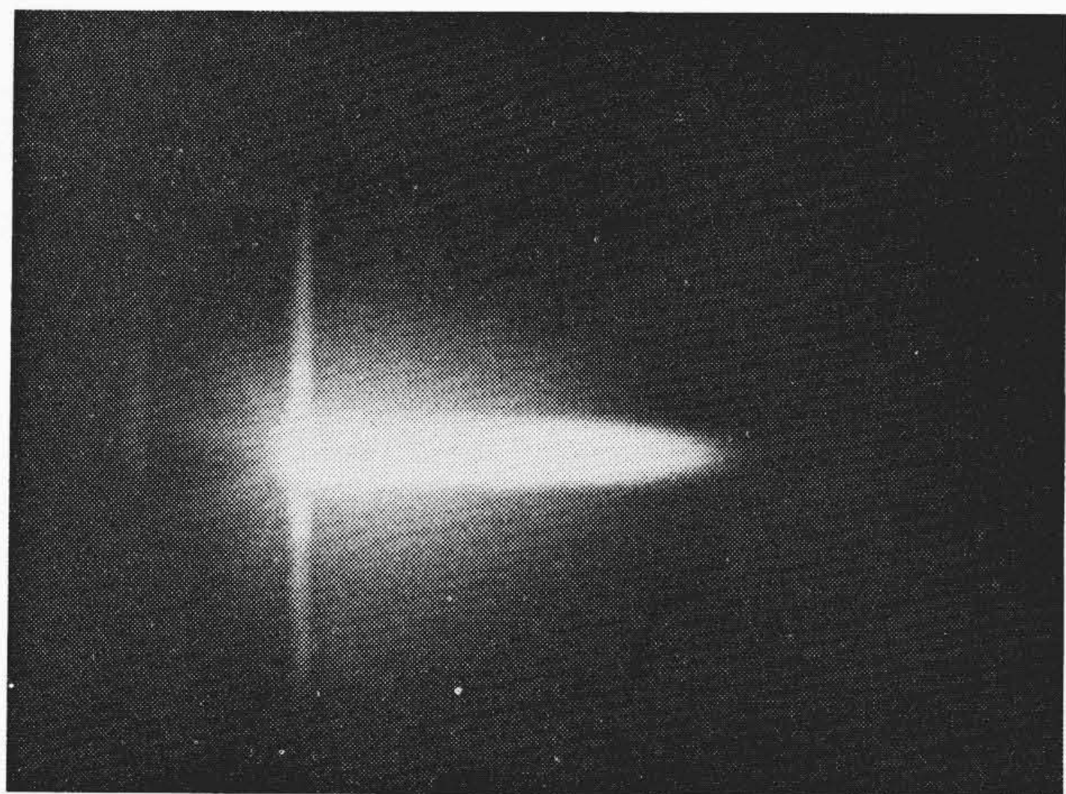
第4図(a) 温度測定したプラズマ・ジェット・フレームの発生状況 発生条件: アーク電流 100 \text{ A} , アーク電圧 62 \text{ V} , アルゴン・水素混合ガス流量 23 \text{ l/min}
