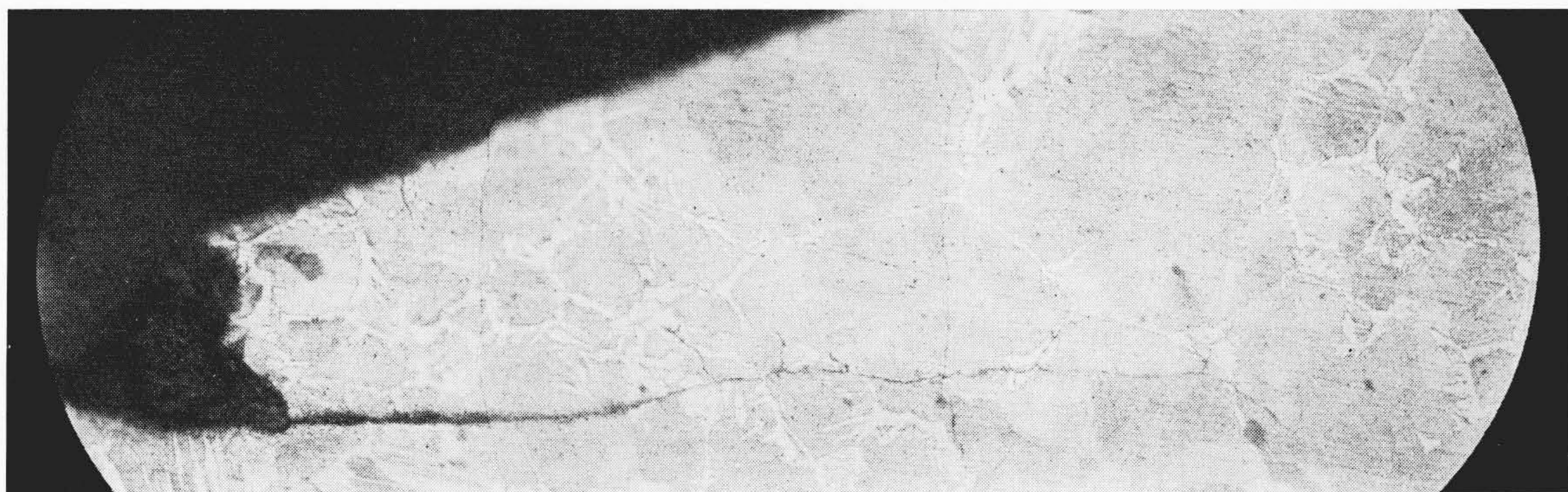
接線力 124 kg/cm, 周速 17.9 m/s, 潤滑油温度 50°C, 負荷繰返し数 9.55 \times 10^6 , 倍率 325 倍
