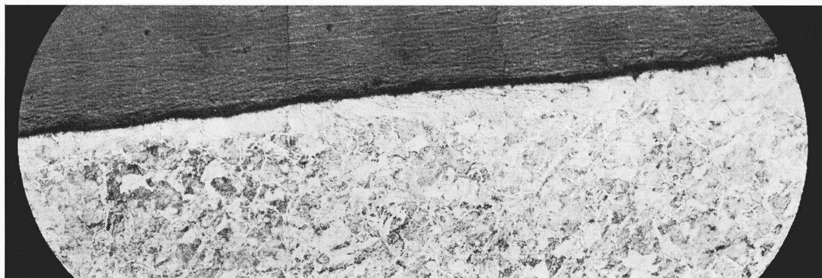
接線力 124 kg/cm, 周速 17.9 m/s, 潤滑油温度 50°C, 負荷繰返し数 9.93 \times 10^6 , 倍率 96 倍
