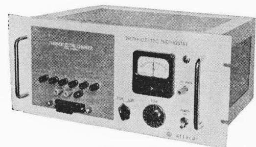
第 22 図 NTB<sub>11</sub> 形小形恒温槽
